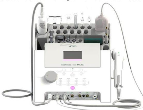
3) Para utilizar as correntes, conecte os pinos banana nos orifícios dos eletrodos. Os pinos dos cabos de aplicação devem ser introduzidos completamente nos eletrodos. Para corrente galvânica conecte a garra de jacaré nos eletrodos de alumínio.
