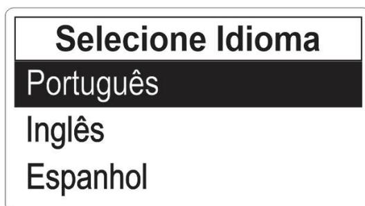
3 – Utilizando as teclas UP e DOWN do comando ADJUST escolha o idioma desejado e pressione a tecla SELECT para confirmar a configuração.
